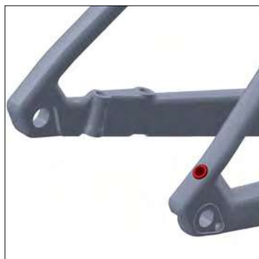
Rear derailleur cable exit
